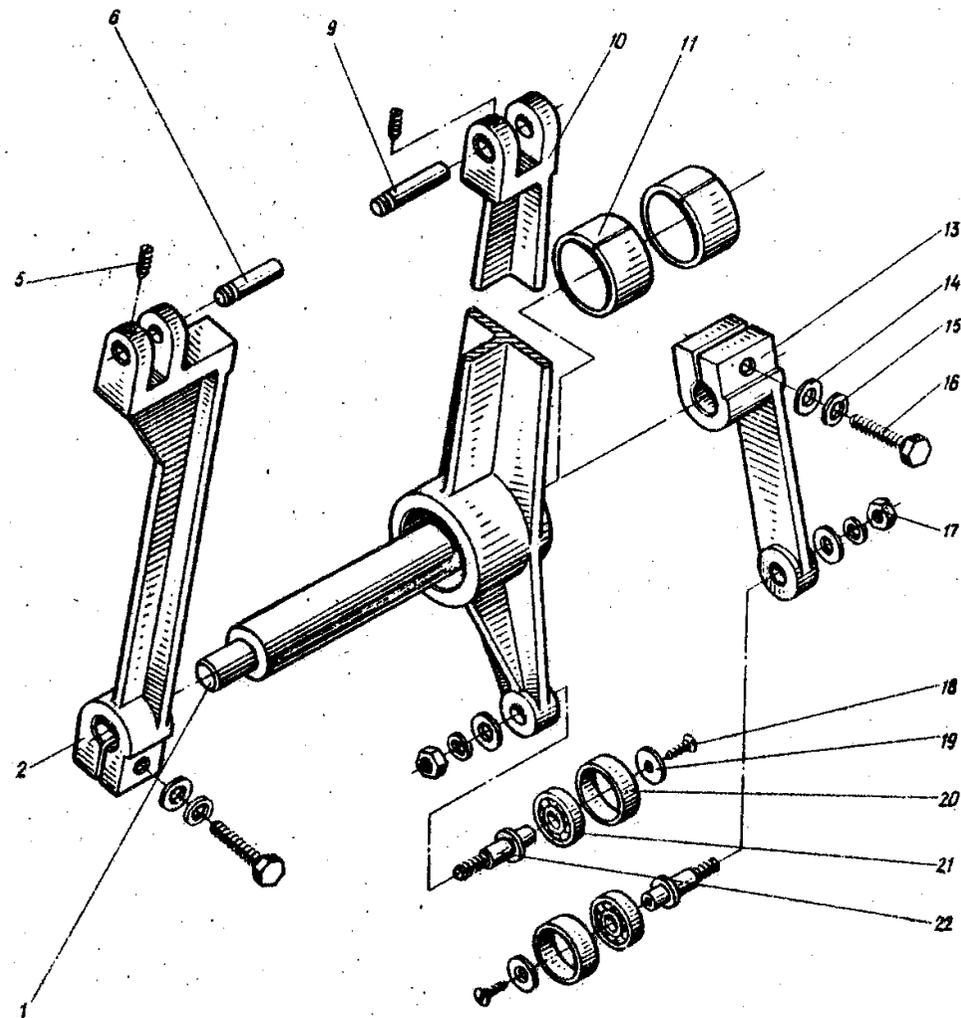
**БНШ-6А -1.04.00.00 Привод механизма подачи и резки нитей**
